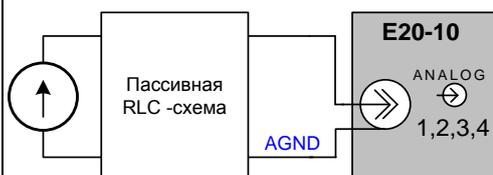
Вход АЦП E20-10 рев."В" может быть подключён к произвольной пассивной RLC-схеме (фильтру, делителю) с учётом входного сопротивления 10 МОм входа АЦП.
