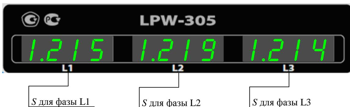
Измеренные значения полной однофазной мощности умножаются на произведение коэффициентов передачи по напряжению и току (ввод коэффициентов осуществляется в меню «Пользовательские настройки» (п.7.3.9)).
