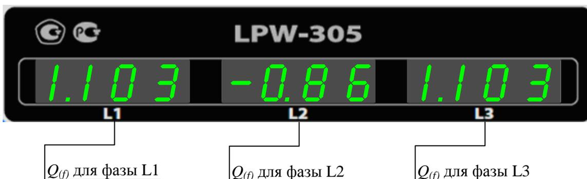
Измеренные значения реактивной однофазной мощности  $Q_{(f)1}$  в полосе частот 40 – 2875 Гц умножаются на произведение коэффициентов передачи по напряжению и току (ввод коэффициентов осуществляется в меню «Пользовательские настройки» (п.7.3.9)).
