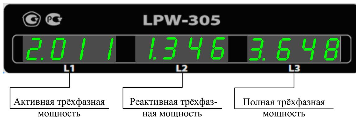
Значения активной трёхфазной мощности в полосе частот 30 – 4000 Гц, реактивной трёхфазной мощности в полосе частот 40 – 2875 Гц, полной трёхфазной мощности в полосе частот 30 – 4000 Гц рассчитываются с учетом коэффициентов передачи по напряжению и току (ввод коэффициентов осуществляется в меню «Пользовательские настройки» (п.7.3.9)).
