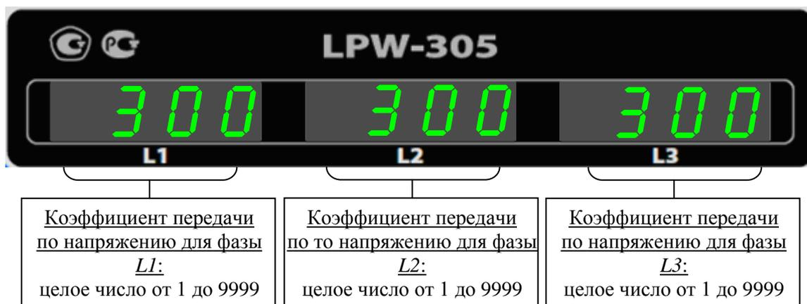
На коэффициент передачи по напряжению будут умножаться следующие параметры:
