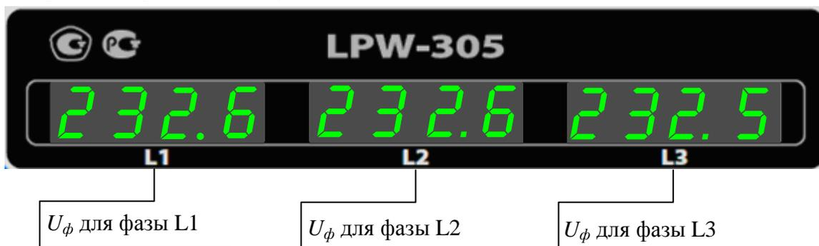
Измеренные значения напряжения  $U_\phi$  умножаются на коэффициент передачи, значение которого задается в пункте «Коэффициент передачи по напряжению» меню «Пользовательские настройки» (п.7.3.9). По умолчанию значение коэффициента передачи равно единице.
