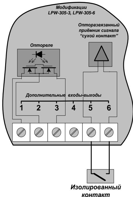
Рисунок Б.15 – Подключение механического контакта к дискретному входу
