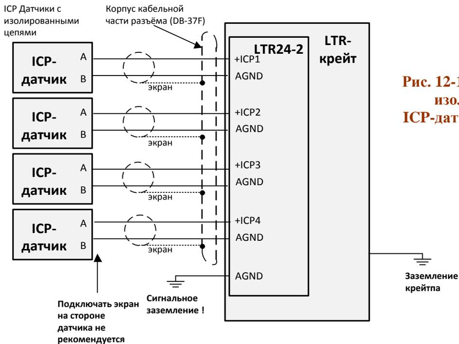
**Рис. 12-10. Подключение изолированных ИСР-датчиков (LTR24-2)**
