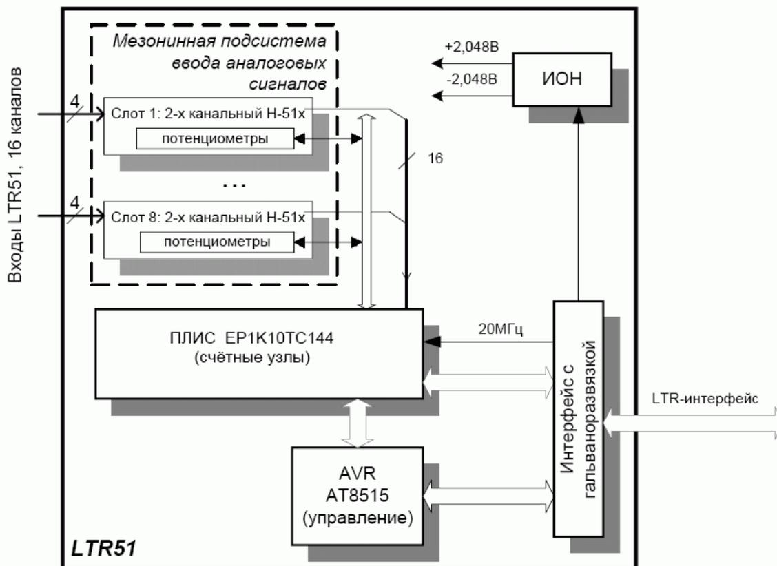
Рис. 10-4. LTR51. Функциональная схема модуля LTR51
