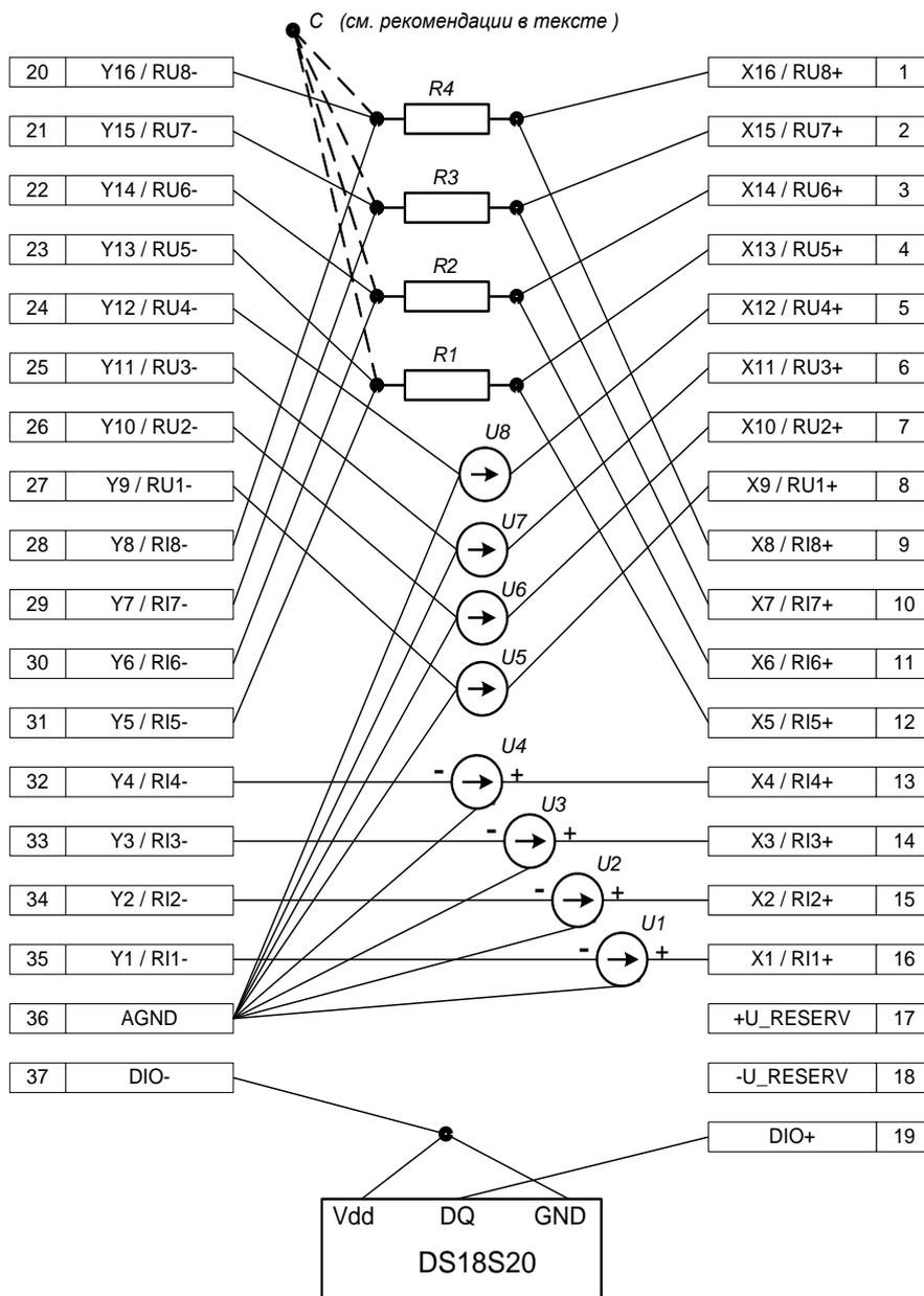
**Рис. 16-5. LTR114. Пример подключения измерительных цепей**
