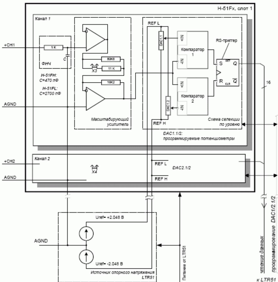
**Рис. 10-5. LTR51/LTR51x. Функциональная схема submodule LTR51x**
