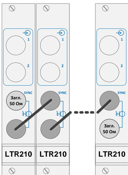
**Рис. 17-8. Схема синхронизации LTR210 “ведущий-ведомые” с полным согласованием линии заглушками 50 Ом по обоим концам линии.**
