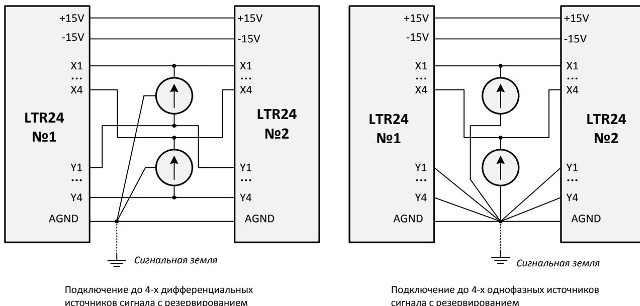
**Рис. 12-13. Примеры резервированного подключения LTR24**
