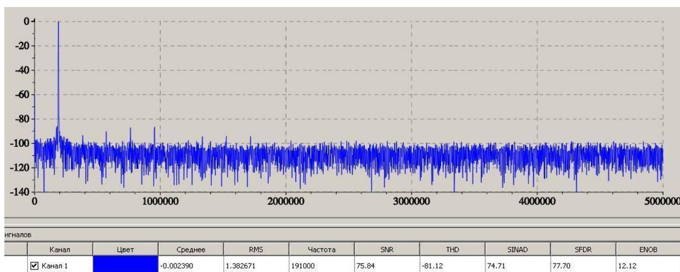
**Рис. 17-4. Спектр синусоидального сигнала. Поддиапазон “±2 В”.**
