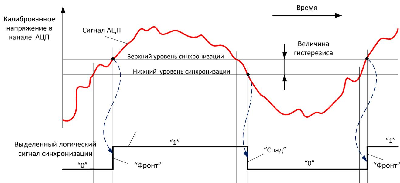
**Рис. 17-7. Принцип гистерезиса при выделении логического сигнала аналоговой синхронизации**
