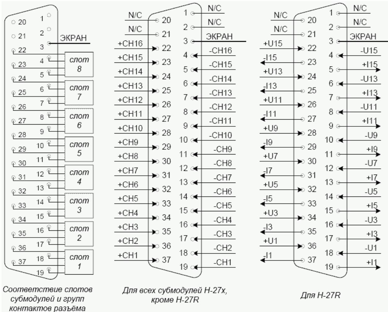
Рис. 7-7. Входные сигналы на разъеме модуля LTR27
