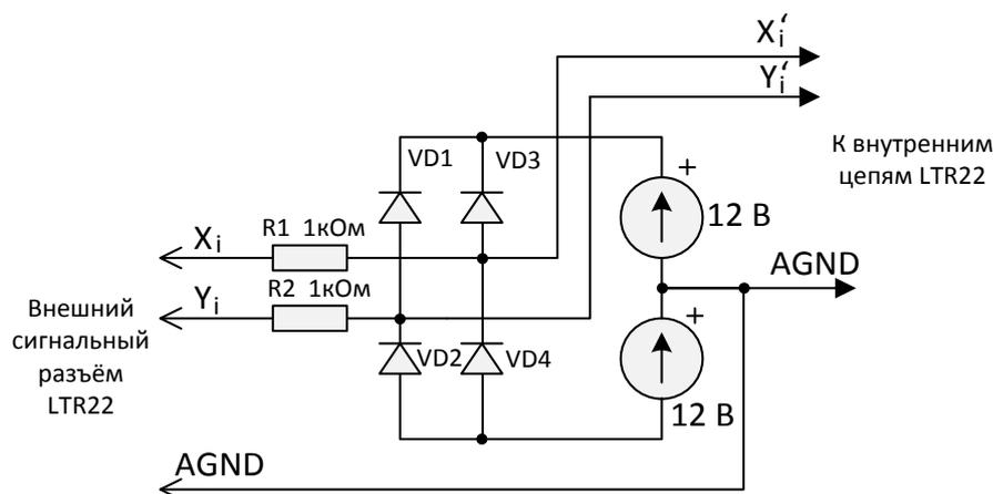
**Рис. 11-5. LTR22. Эквивалентная схема защиты входов.**
