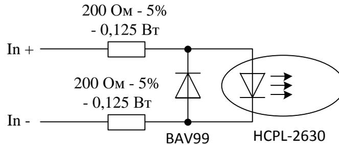
**Рис. 9-2. Электрическая схема входной цепи LTR41.**
