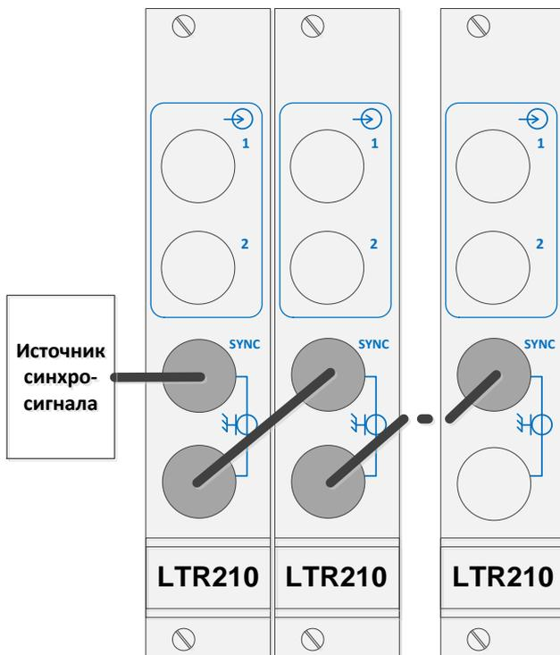
**Рис. 17-10. Схема синхронизации LTR210 с частичным согласованием линии на стороне источника сигнала. Требуется источник сигнала с выходным сопротивлением 50 Ом.**
