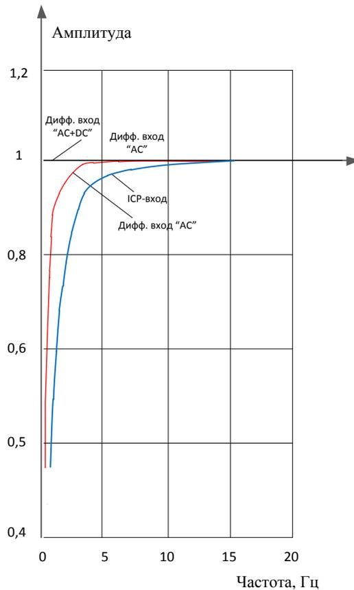
**Рис. 12-3. АЧХ в области низких частот LTR24**
