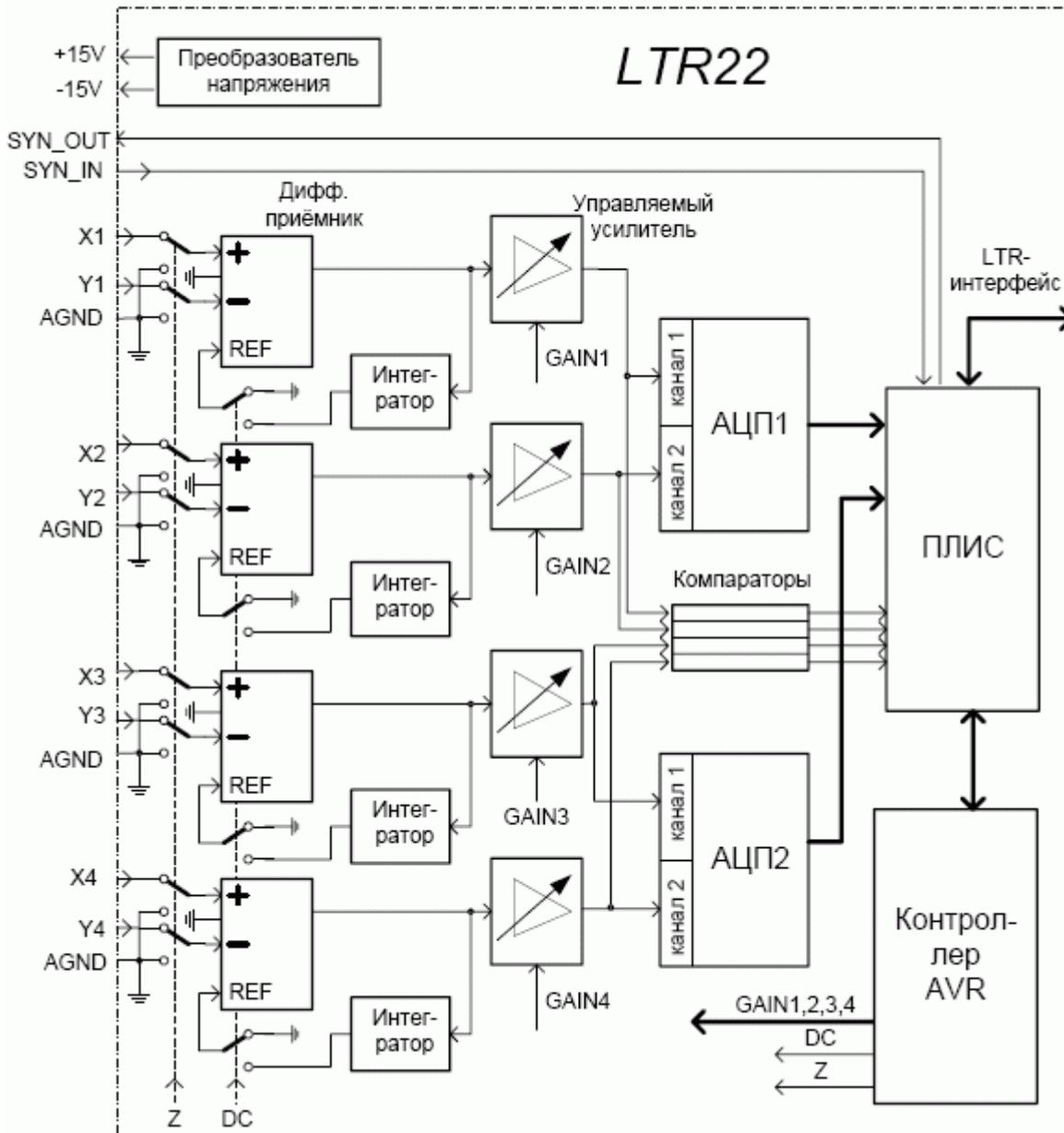
**Рис. 11-2. LTR22. Функциональная схема.**
