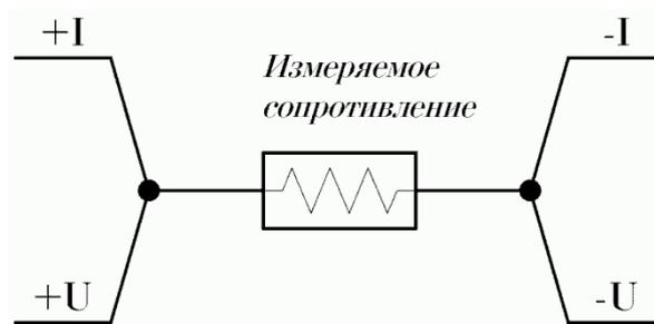
Рис. 7-8. 4-проводное подключение для случая с H-27R
