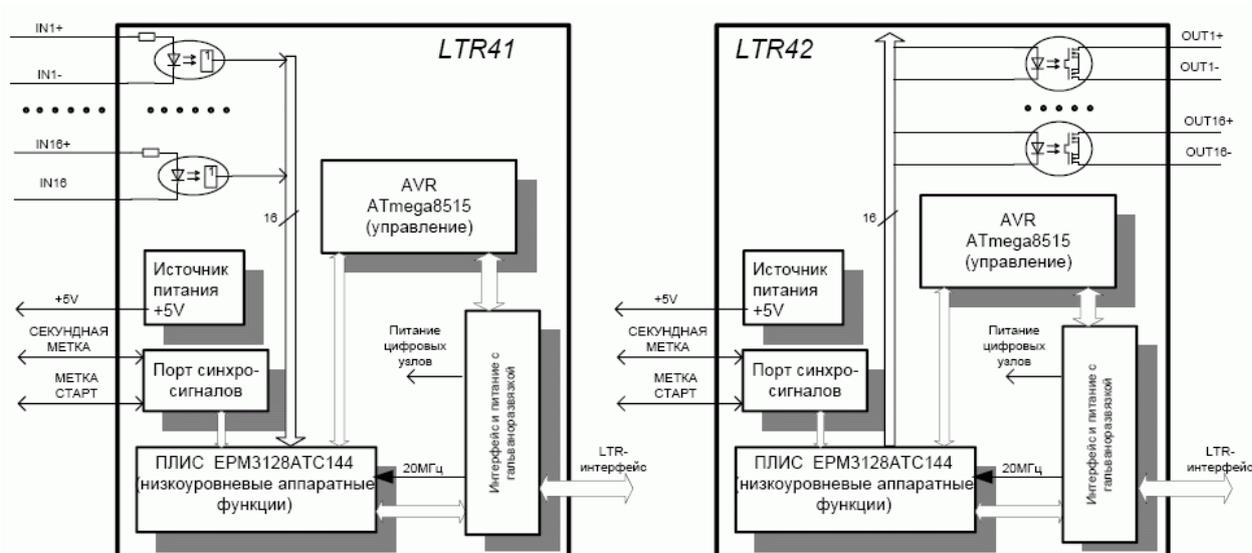
**Рис. 9-1. Функциональные схемы модулей LTR41, LTR42**
