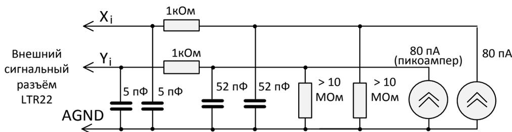
**Рис. 11-6. LTR22. Электрическая эквивалентная схема входных цепей.**
