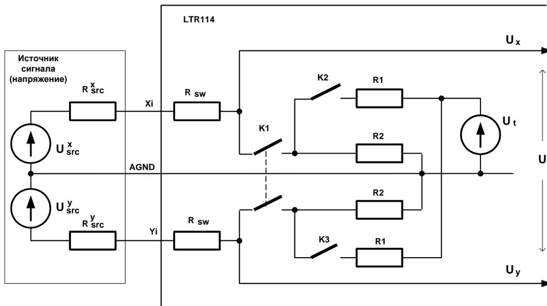
Рис. 16-12. Режим проверки входных линий. Источник сигнала – напряжение
