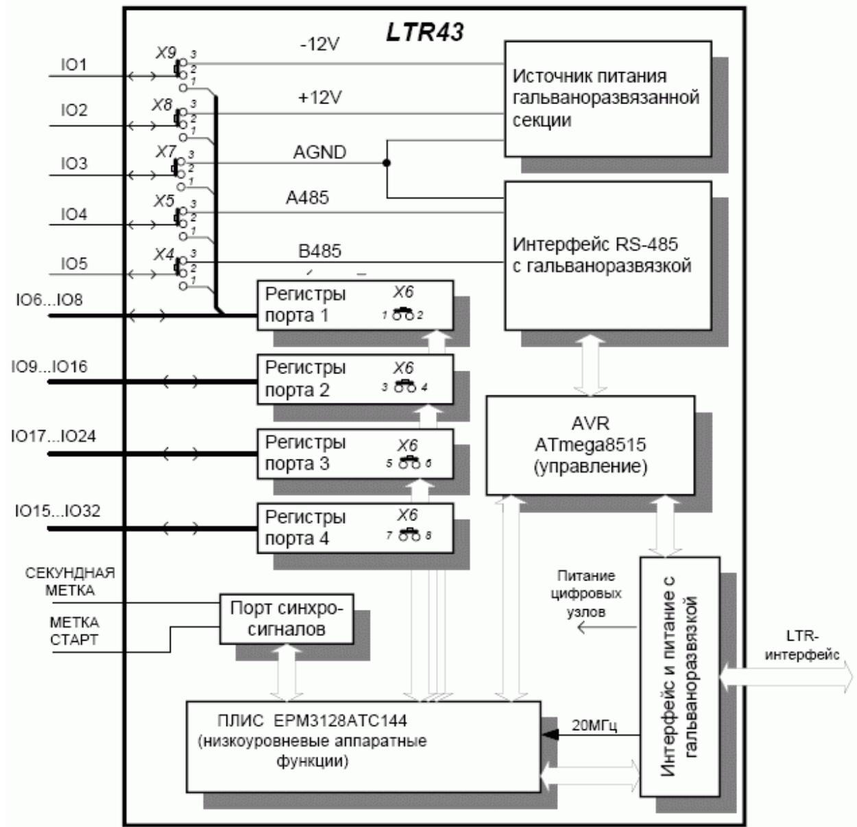
Рис. 8-3. Функциональная схема модуля LTR43
