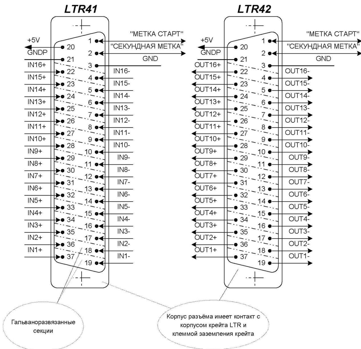
**Рис. 9-4. Сигналы на разъемах модулей LTR41 и LTR42**
