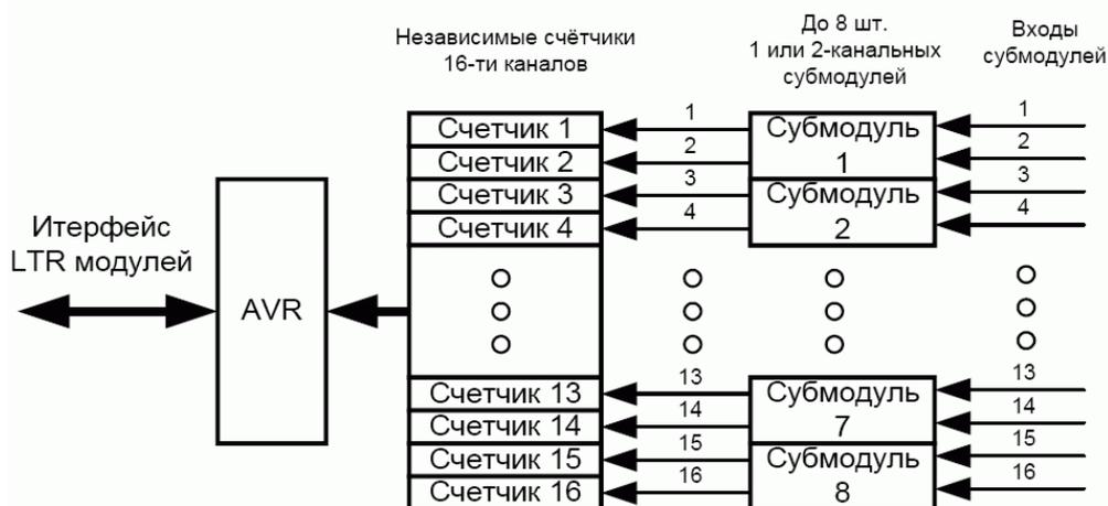
**Рис. 7-2. Функциональная схема модуля LTR27**
