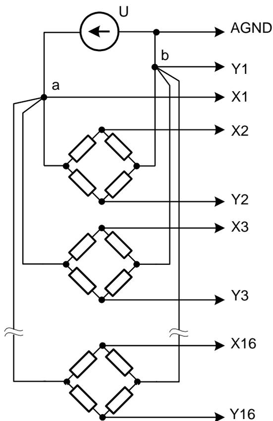
**Рис. 16-7. LTR114. Пример подключения 15-ти мостов с внешним питанием**
