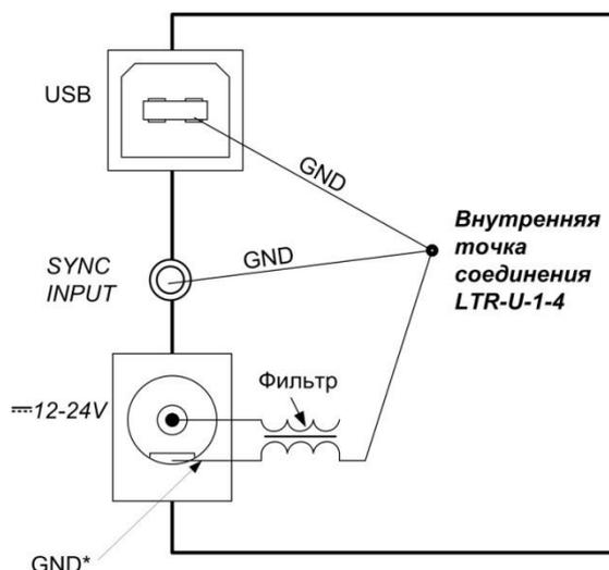
**Рис. 3-12. Внутреннее соединение общих проводов интерфейсов в LTR-U-1-4**
