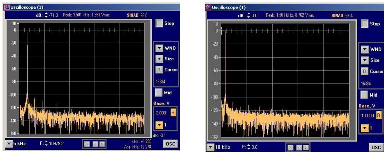
Приведённые выше амплитудные спектры сигналов сняты при подаче синусоидального сигнала 1,3 кГц на дифференциальные входы LTR24 при настройке на поддиапазоны “2 В” (спектр слева) и “10 В” (спектр справа). Уровень “0 dB” на спектре соответствует максимальной амплитуде сигнала в установленном поддиапазоне. Используется БПФ на 20000 точек с окном Блэкмана-Харриса.
