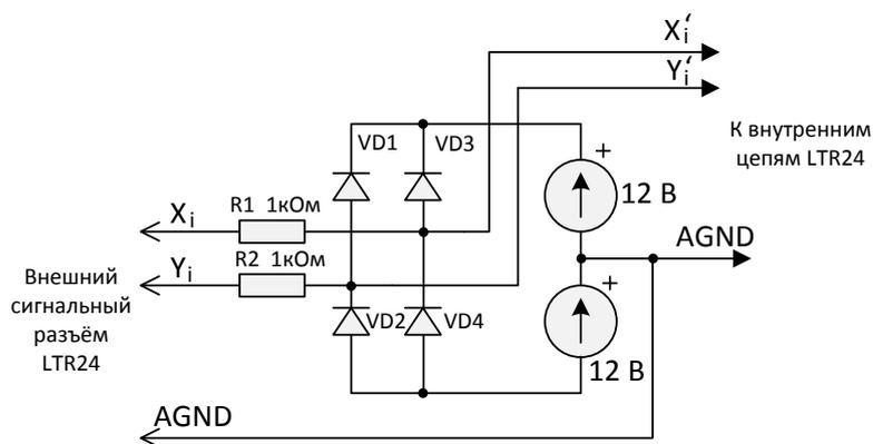
**Рис. 12-7. LTR24. Эквивалентная схема защиты входов “X”, “Y” (рабочий режим).**
