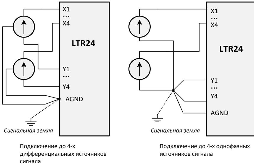
**Рис. 12-9. Подключения источников сигнала к LTR24**
