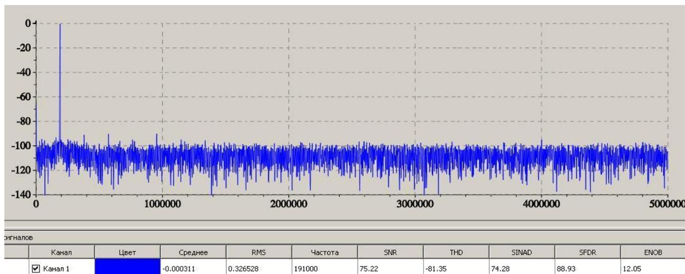
**Рис. 17-3. Спектр синусоидального сигнала. Поддиапазон “±0,5 В”.**
