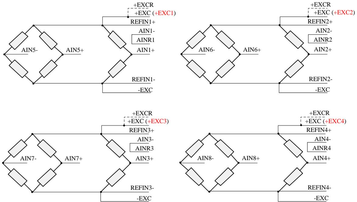
**Рис. 6-10. LTR212(M). Полумосты и полные мосты (8-канальный режим)**
