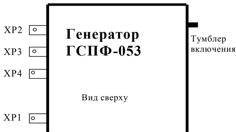
Рис. 7. 1. Схема размещения разъемов
