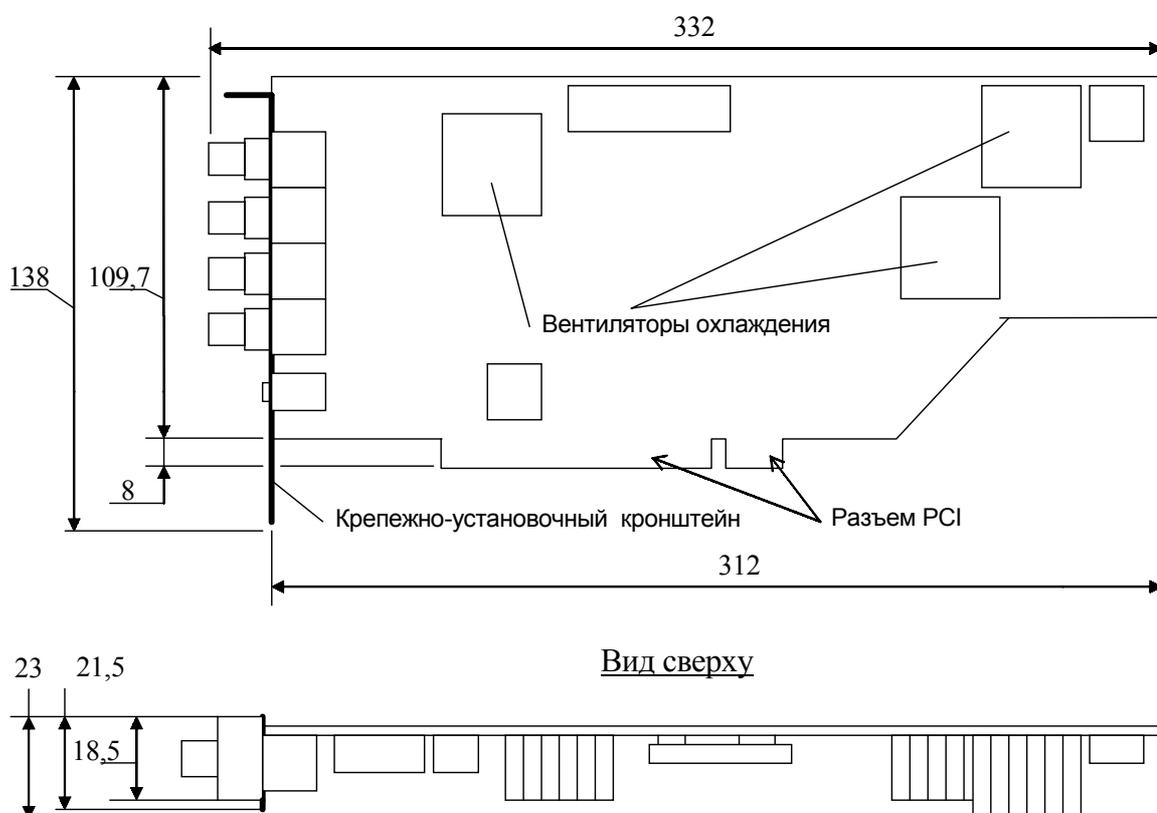
**Рис. 5. 1** Габаритные размеры платы ЛА-н1РСІ
