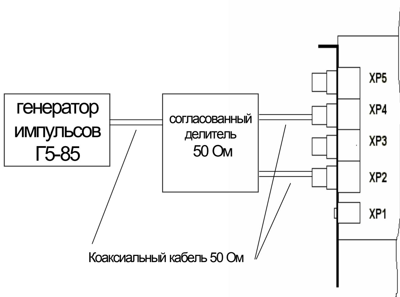
Рис. 5.4 Схема калибровки измерителя временных интервалов ЛА-н1РСІ
