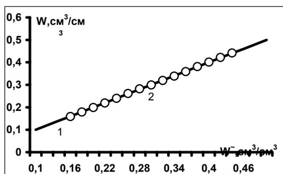
Рис.2. Оценочные значения влажности  $\tilde{W}$ , получаемые при использовании нейросетевого алгоритма обработки двух радиояркостных температур  $T_{Я}$  для длин волн  $\lambda_1 = 5$  см и  $\lambda_2 = 21$  см как функция точных значений  $W$  (температура почвы  $T_{П} = 20^{\circ}C$ ): 1 – точные значения  $W$ ; 2- оценочные значения  $\tilde{W}$ .
