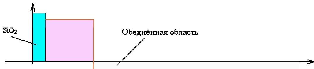
Рис.2а. Распределение зарядов в скрытом канале.
