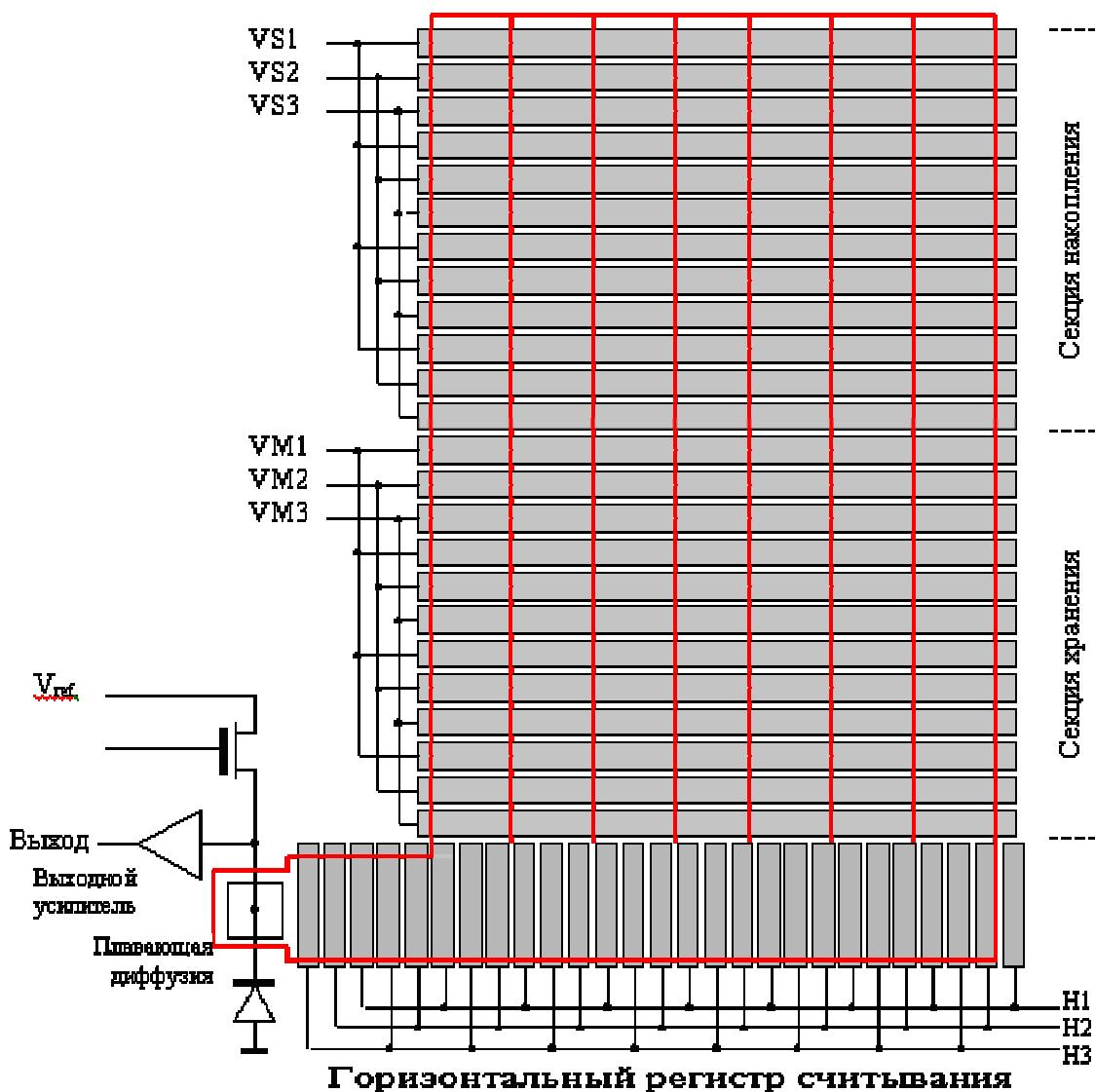
**Рис.4а. Простейшая структура двумерной матрицы ПЗС.**
