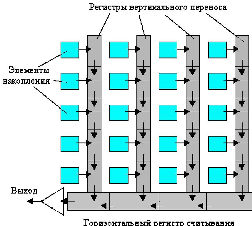
**Рис.46. Приборы с межстрочным переносом.**
