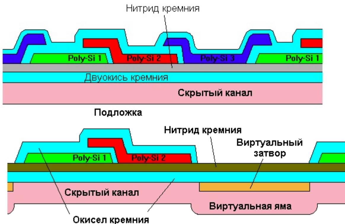
**Рис.5. Сечение трёхфазного ПЗС с электродами из поликристаллического кремния (вверху) и с виртуальной фазой (внизу).
