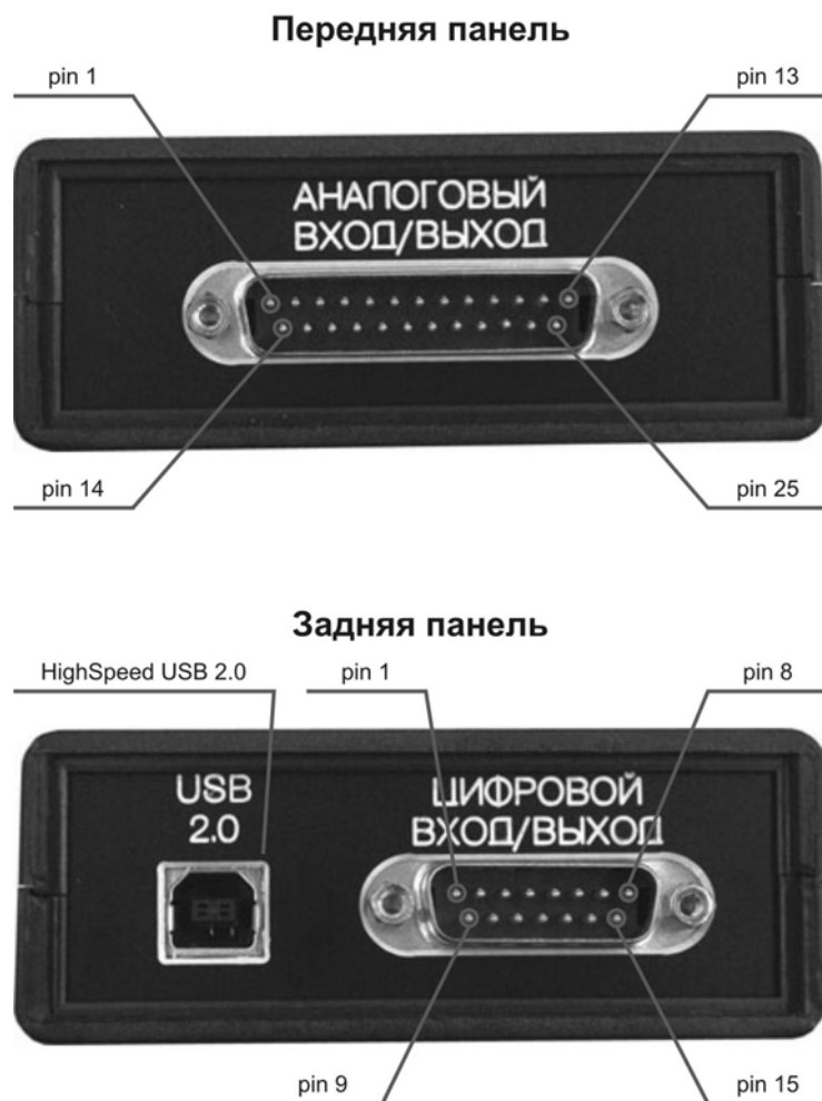
Рисунок 7.3 – Общий вид модуля АЦП-ЦАП 16/16 «SigmaUSB» со стороны задней и передней панелей
